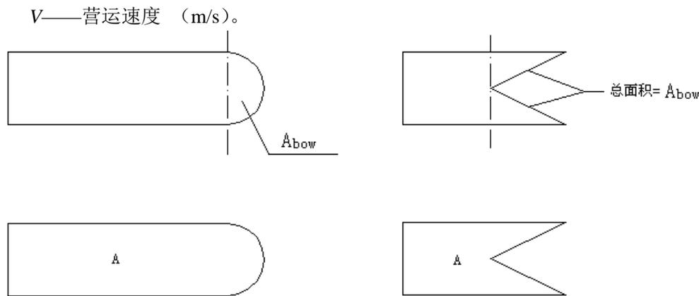
图 10.4.1.1 两种不同船型的平面图
