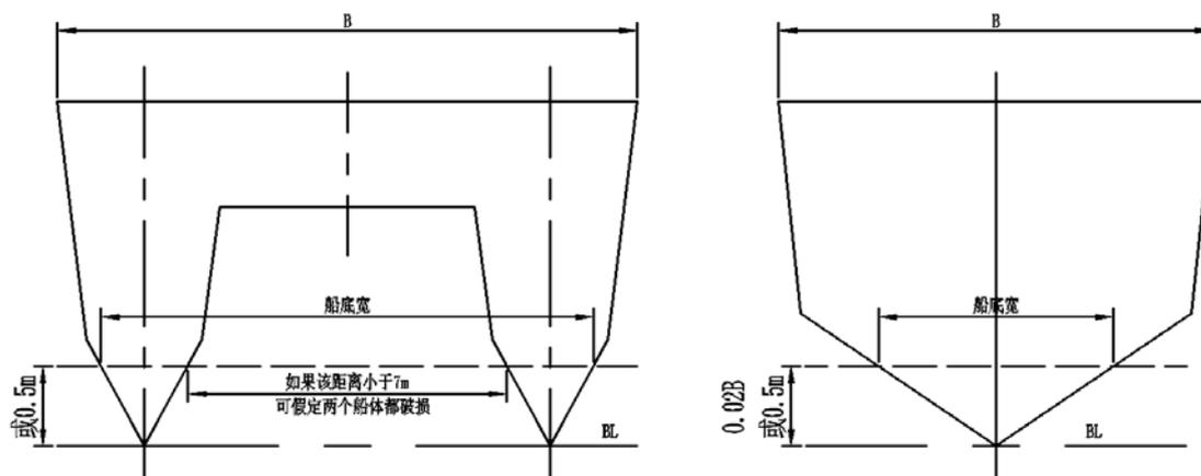
图 4.6.1.2 船侧和底部破损的横向范围
